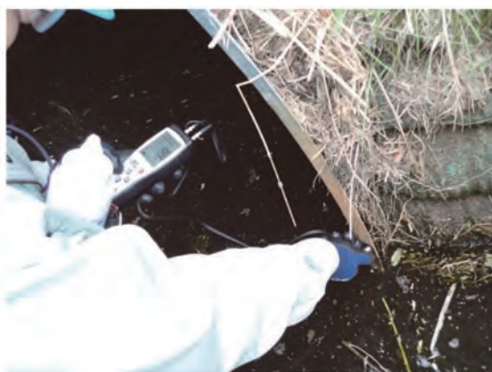
写真－５ 板厚の測定
